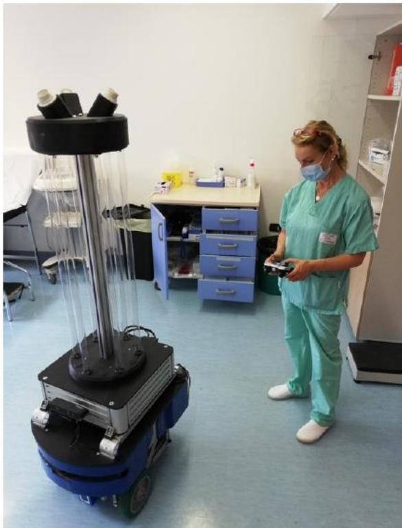
Con il progetto Samaritan, finanziato da **Fondazione Marmo** e Il Talento all'Opera, è stato possibile sviluppare un robot a lampade UV-C che è stato caratterizzato e testato come un dispositivo per la sanificazione ambientale a tutti gli effetti.
